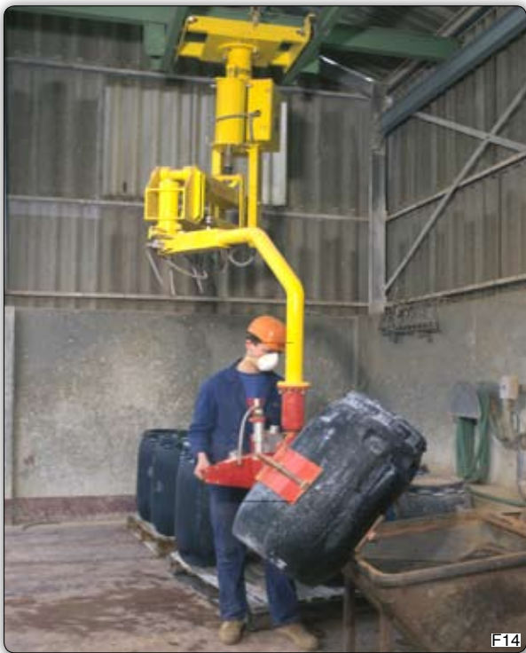
Манипулятор Partner типа PMS в подвесном передвижном исполнении, предназначенный для обслуживания нескольких рабочих мест и представленный специальной моделью для опорожнения бочек.
