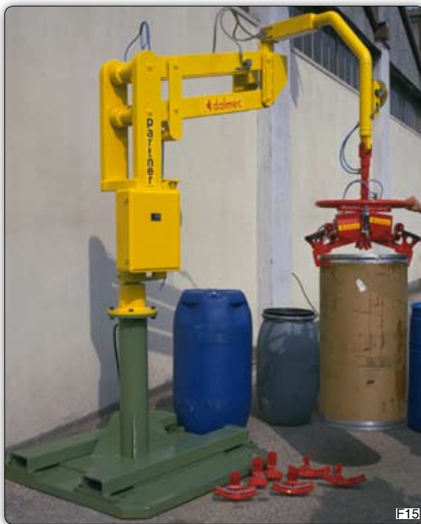
Манипулятор Partner типа PMC в исполнении на стойке, предназначенный для захвата и перемещения бочек разного веса и формы. Захват разных бочек обеспечивается путем быстрой смены взаимозаменяемых адаптеров в приспособлении для захвата.
