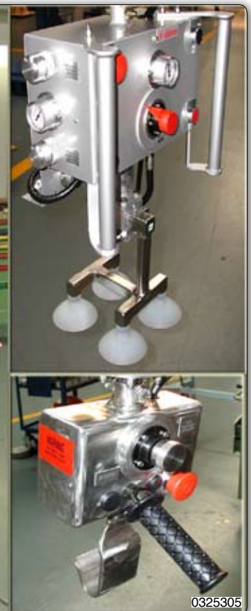
Приспособления для захвата из нерж. стали для облегчения уборки и обеспечения санитарии на рабочем месте: - приспособление с зажимными губками для захвата и опорожнения бочек разных размеров и веса; - приспособление с вакуумными присосами; вакуум генерируется эжектором "Venturi"; - простой крюк для перемещения бочонков.
