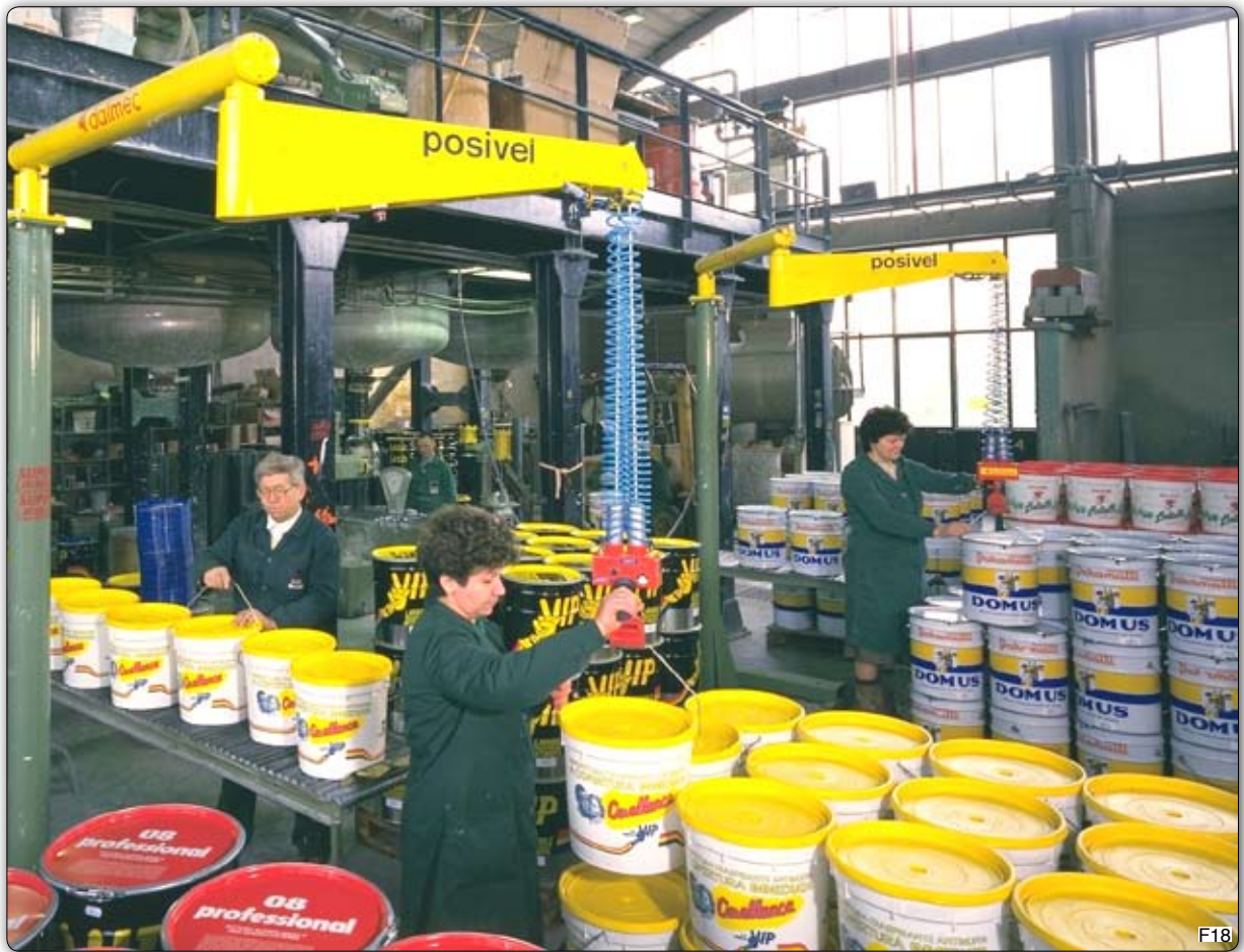
Манипулятор Posivel типа PVC в исполнении на стойке, оборудован профильным плоским крюком для штабелировки ведер.
