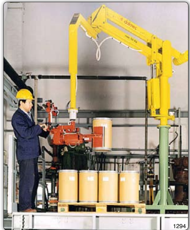
Манипулятор Partner типа PMC в исполнении на стойке, предназначен для захвата и опорожнения бочонков.
