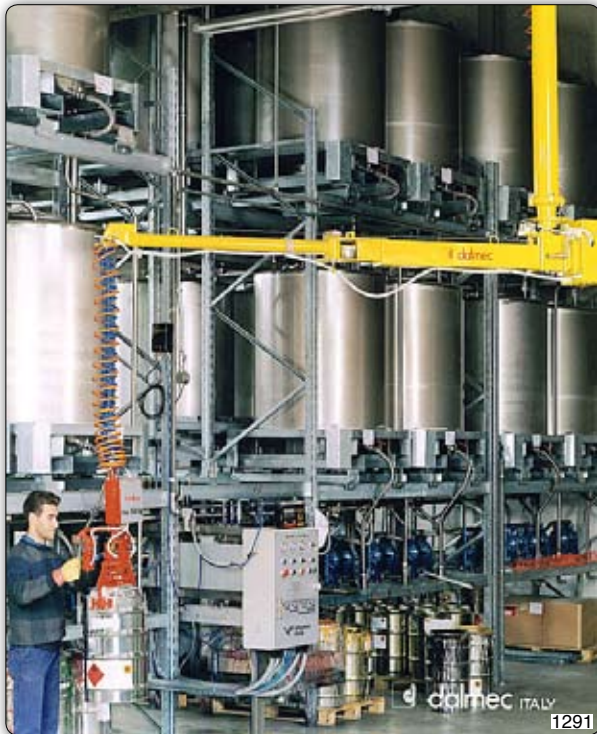
Манипулятор Posifil типа PFF в подвесном не передвижном исполнении, предназначен для перемещения бочонков.
