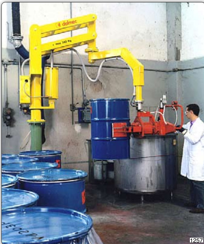
Манипулятор Maxipartner типа MXC в исполнении на стойке, предназначенный для захвата и опорожнения бочек весом до 400 кг.
