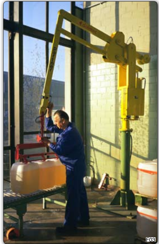
Манипулятор Partner PSC в исполнении на стойке с приспособлением для подъема одновременно нескольких канистр и для их перемещения с линии упаковки на поддон.
