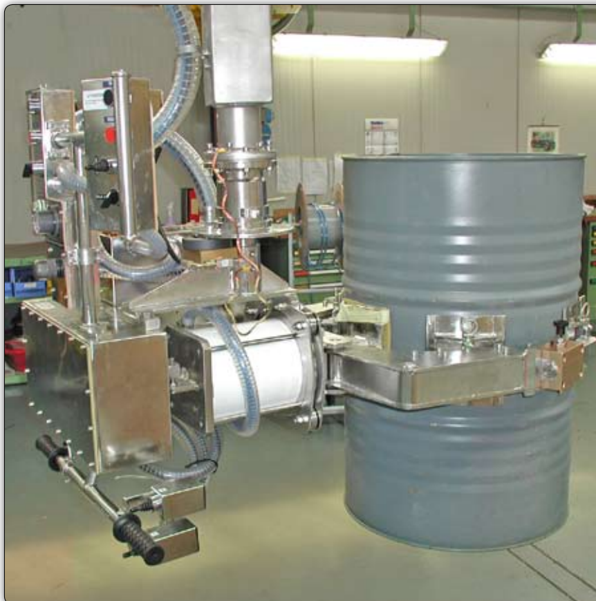
Приспособления для захвата из нерж. стали для облегчения уборки и обеспечения санитарии на рабочем месте: - приспособление с зажимными губками для захвата и опорожнения бочек разных размеров и веса; - приспособление с вакуумными присосами; вакуум генерируется эжектором "Venturi"; - простой крюк для перемещения бочонков.
