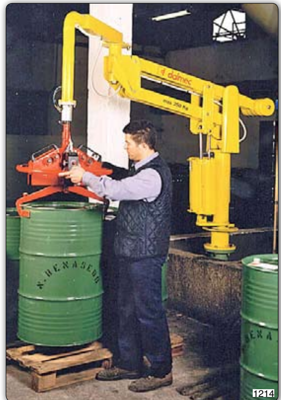
Манипулятор Partner типа PMS в исполнении на стойке, оборудованный приспособлением для захвата бочек за верхнюю кромку.
