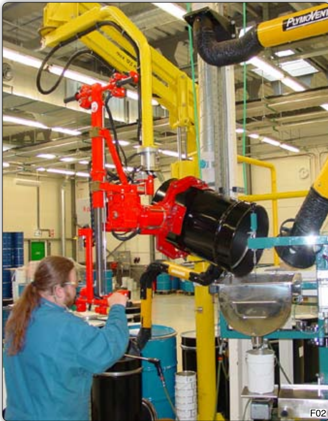
Манипулятор Partner типа PMS в исполнении на стойке, предназначенный для захвата и опорожнения бочек.
