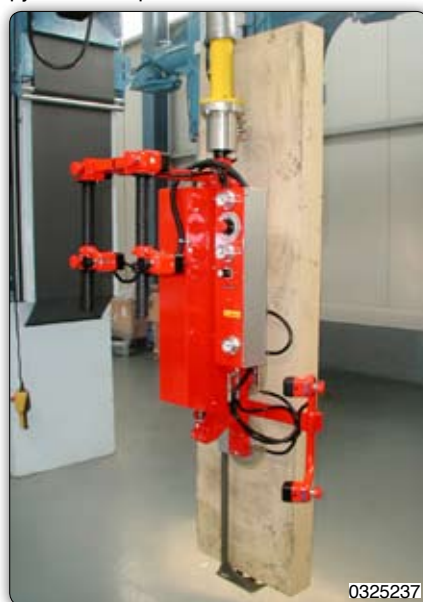
Приспособление с присосами и центровками для перемещения и наклона специальных панелей.
