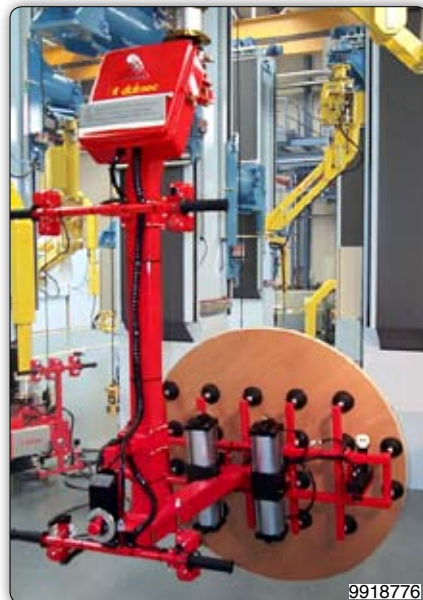
Приспособление с присосами для перемещения деревянных панелей с переворотом на 180° при помощи пневмопривода.
