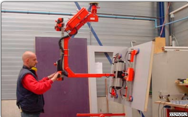
Приспособление с присосами, регулируемые вручную для перемещения деревянных панелей разного размера с переворотом на 180° при помощи пневмопривода.
