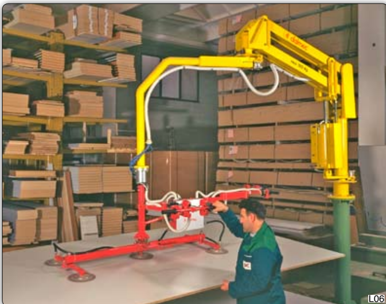
Манипулятор Partner типа PMC в исполнении на стойке, оборудованный приспособлением с присосами для захвата с поддона и позиционирования панелей ДСП на кройном станке.
