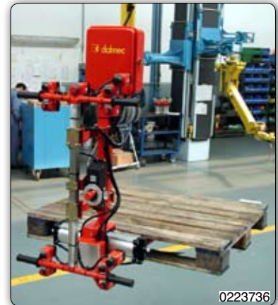
Вилчатое приспособление с поворотом груза при помощи пневмопривода.
