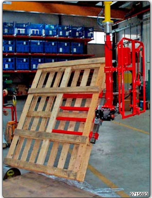
Вилчатое приспособление с пневматическим переворотом на 180° для захвата и поворота поддонов.
