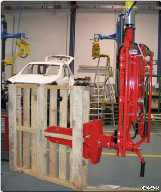
Клещевое приспособление для захвата с ручным вращением поддонов.
