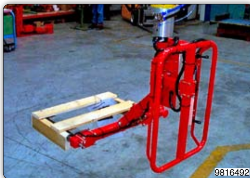
Вилчатое приспособление с устройством детекции груза – для перемещения поддонов.
