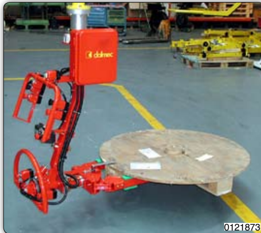
Приспособление для захвата и ручного поворота специальных поддонов.
