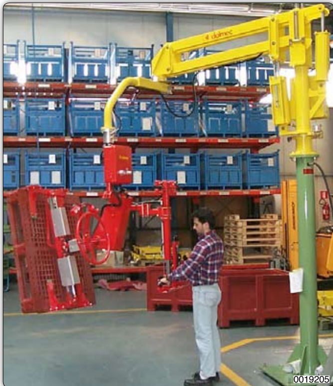
Манипулятор Partner типа PMC в исполнении на стойке с клещевым приспособлением для захвата, пневматического наклона и ручным вращением пластмассовых поддонов.
