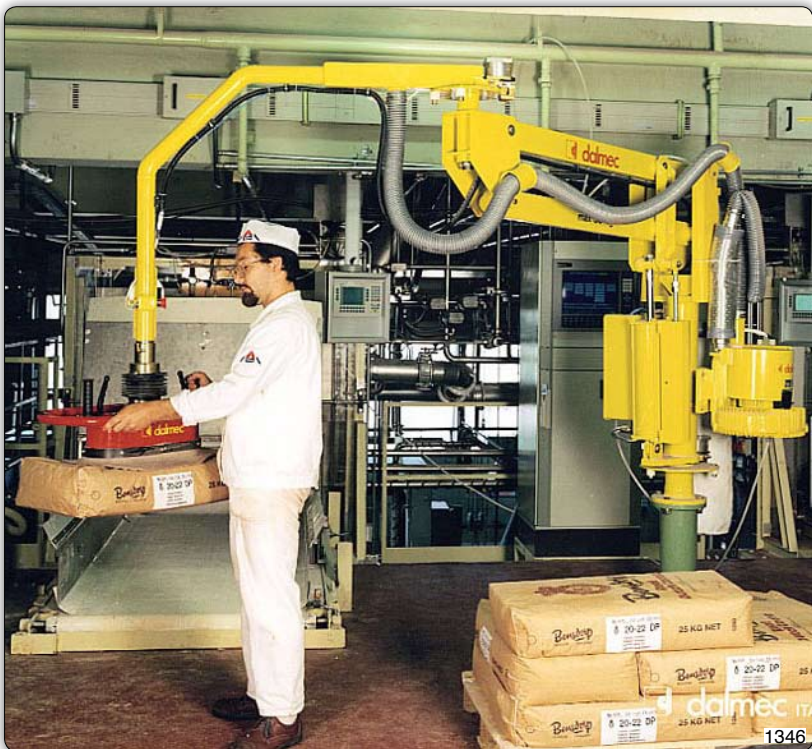
Манипулятор Partner типа PMS в исполнении на сниженной стойке для возможности работы с малой высотой перемещений. Данное оборудование обеспечивает снятие мешков с поддона и их разгрузку на бункер.
