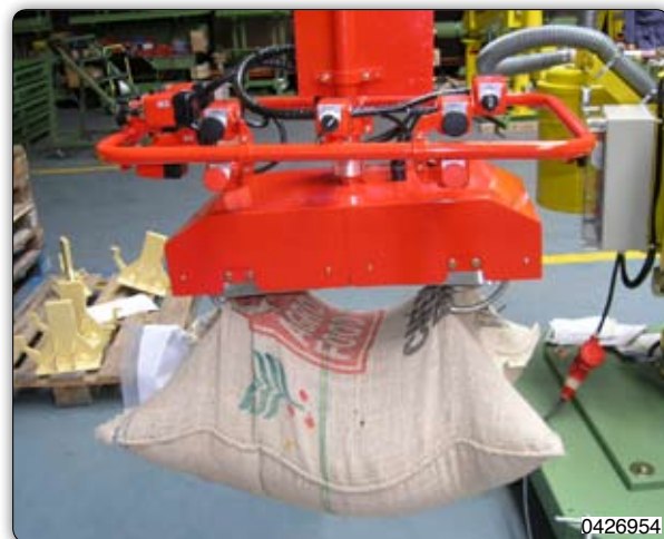
Манипулятор с приспособлением с убирающимися крюками для захвата мешков из мешковины.
