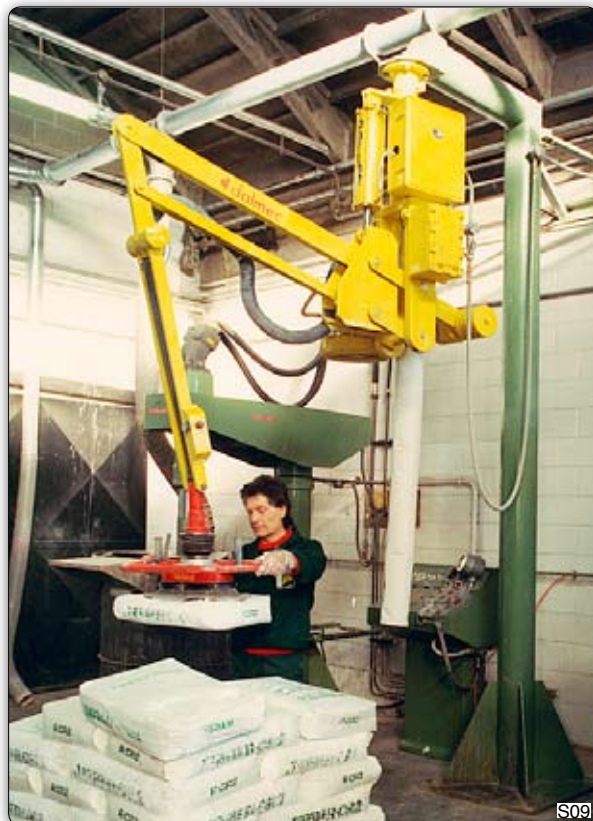
Манипулятор Partner типа PSF в подвесном исполнении, используемый для перемещения мешков от наполнительной машины на поддон.
