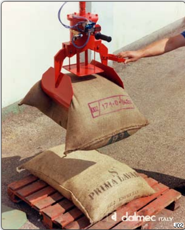
Манипулятор с пневматическим приспособлением с плоскими зажимами для захвата мешков из мешковины, содержащими кофе, какао и аналогичные продукты.
