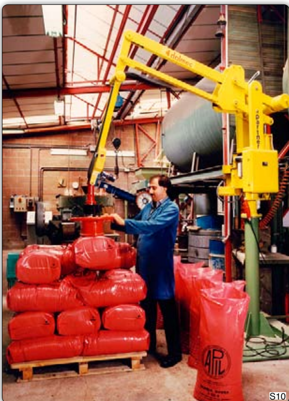
Манипулятор Partner типа PSC в исполнении на стойке, используемый для перемещения мешков от наполнительной машины на поддон.
