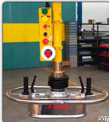
Присос, изготовленный из нержавеющей стали.
