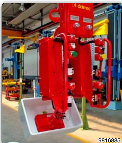
Манипулятор с приспособлением с присосами (Venturi) для захвата и наклона моек.
