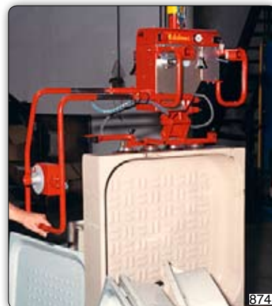
Манипулятор Partner типа PMF в подвесном исполнении с приспособлением с присосами ("Venturi") для захвата, поворота вручную и перемещения душевых поддонов.
