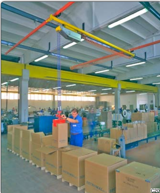
Манипулятор Partner типа MPS в подвесном передвижном исполнении на траверсе, оборудованный пневматическим приспособлением с зажимами для захвата и перемещения коробок, имеющих разные размеры и вес. Приспособление для захвата оборудовано пропорциональным клапаном для облегчения оператору поиска соответствующего уравновешивания. Траверса и продольные ходовые пути – нашей разработки.
