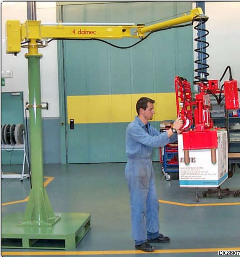
Манипулятор Posifil типа PFC в исполнении на стойке, оборудованный приспособлением для захвата сантехники, ее позиционирования в упаковочные картонные коробки, захвата запечатанных коробок и их разгрузки на поддон.
