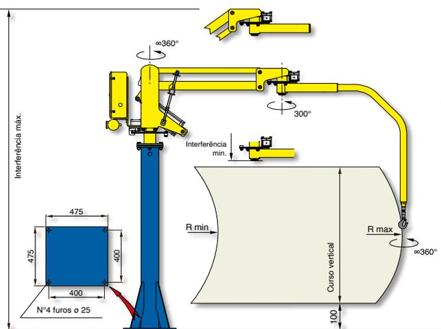
Versão estrutural: em base fixa, em base auto-estável oportunamente dimensionado, ou com carrinho auto-estável motorizado deslizante ao longo de um simples trilho posicionado no piso.
